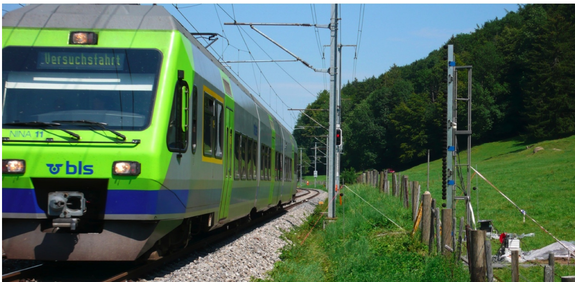
Abbildung 1: Messstelle mit Mikrofon-Array während der Vorbeifahrt eines Messzuges.
